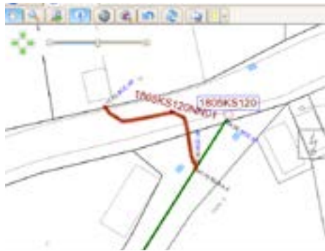
3D-GeoSense-Inspektion mit Live-Rohrverlaufsdarstellung in Plan und Höhenprofil.
